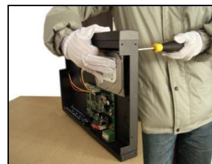
3. закрутите винты жесткого диска
