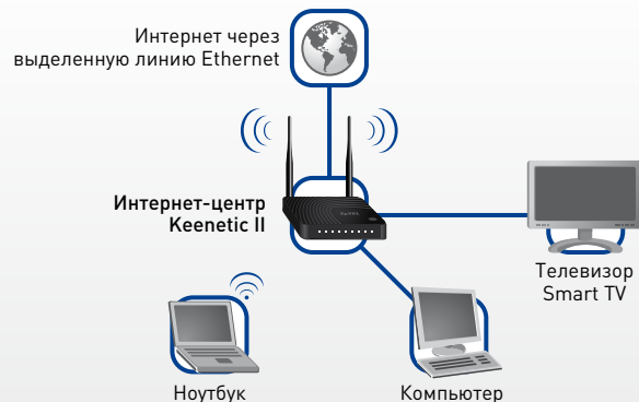
Подключение по выделенной линии Ethernet
